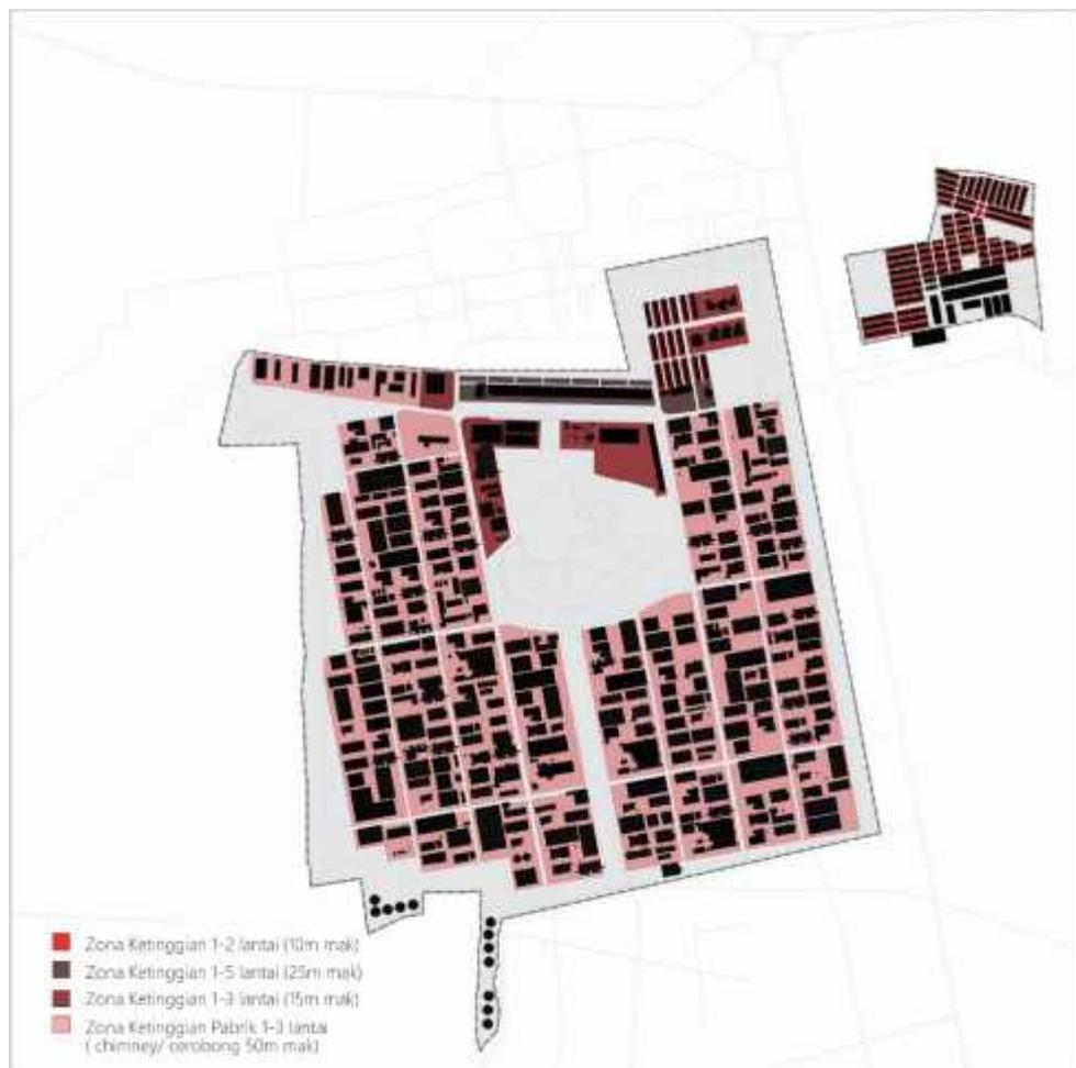
Gambar 60. Pengaturan Ketinggian Lantai Bangunan
